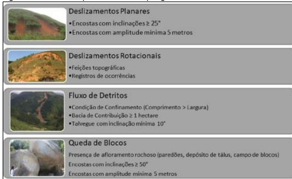
Figura 463 - Critérios para identificar o perigo a movimentos de massa.
